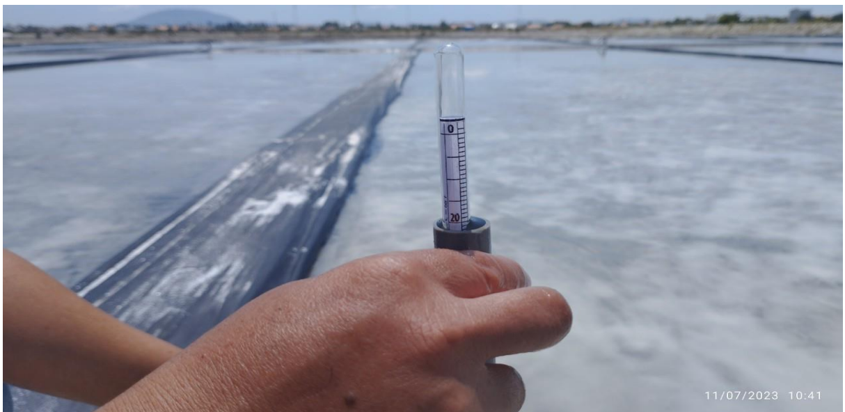
Hình 3. Sử dụng Bômê kế đo nồng độ nước biển khu sản xuất muối
